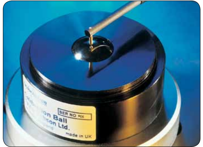
通过球校准检查测针状况、传感器量程和线性度
